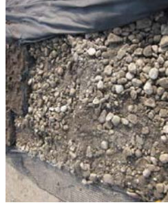
322 Strukturální zemina brání zhutnění a zajišťuje přístup kyslíku. Přitom umožňuje pokládání dlažby podobně jako na rostlý terén
